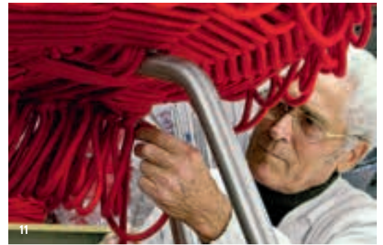
10 Präzise Das klassische Korbgeflecht der Thonet-Stühle wird von Hand eingefügt
